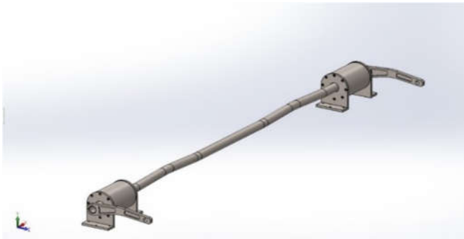
Hình 3. Thanh ổn định ngang sử dụng dầu từ trường MR
